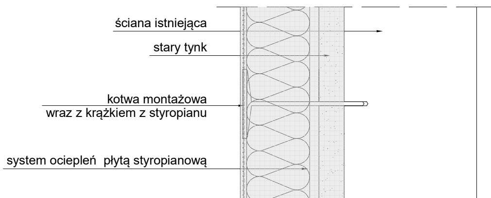
Schemat kotwienia
